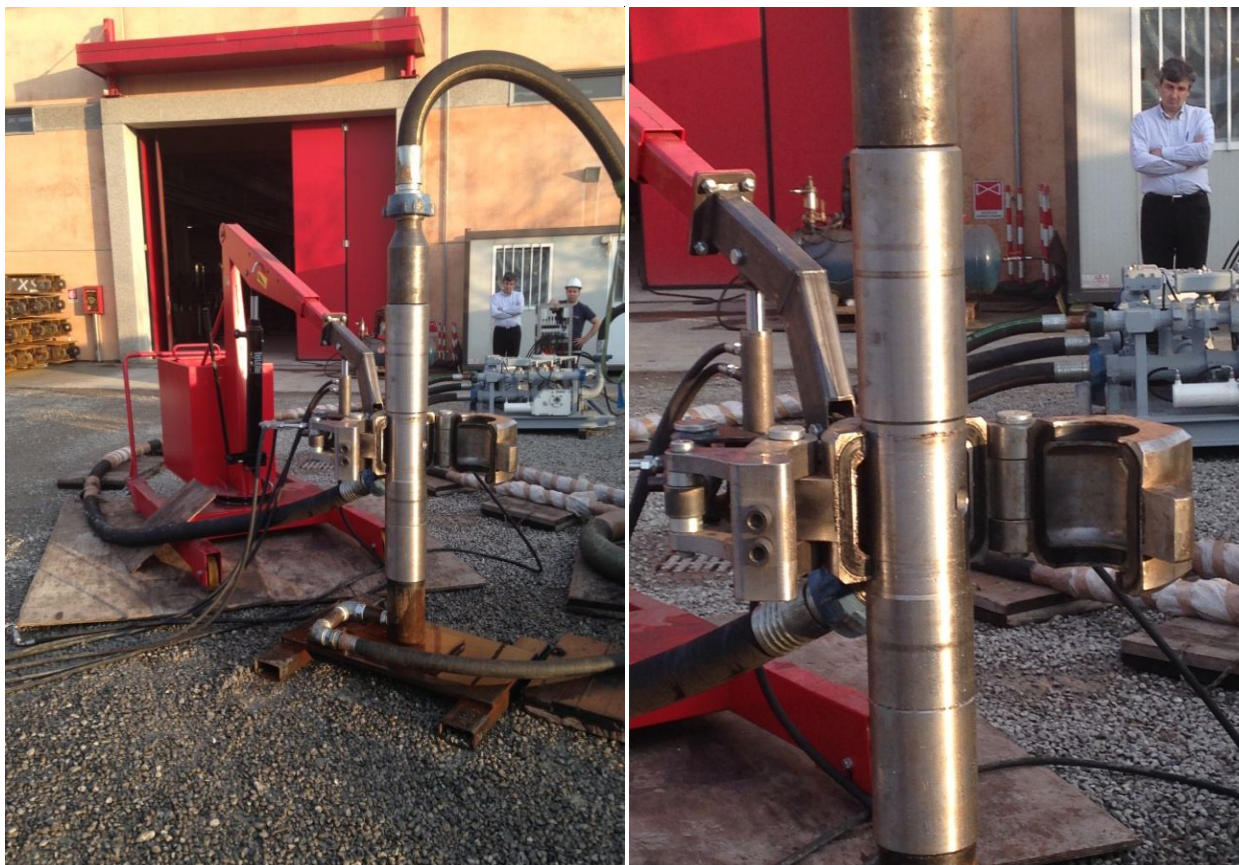
Рис. 4. Силовая гидравлическая «рука» с пакером и специальным переводником на СБТ
